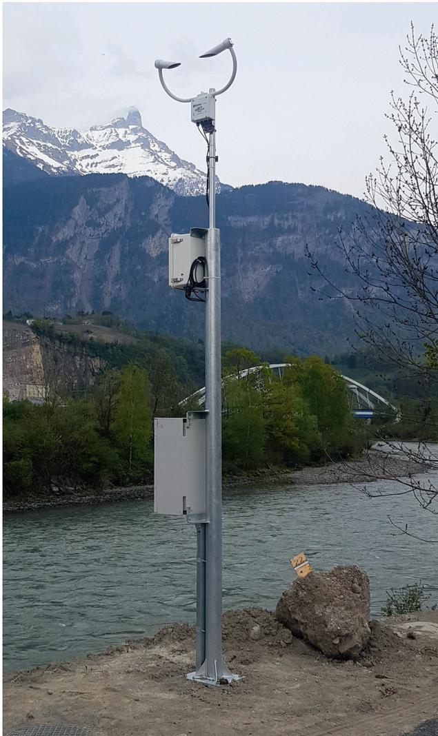
Dispositif de détection de brouillard.
